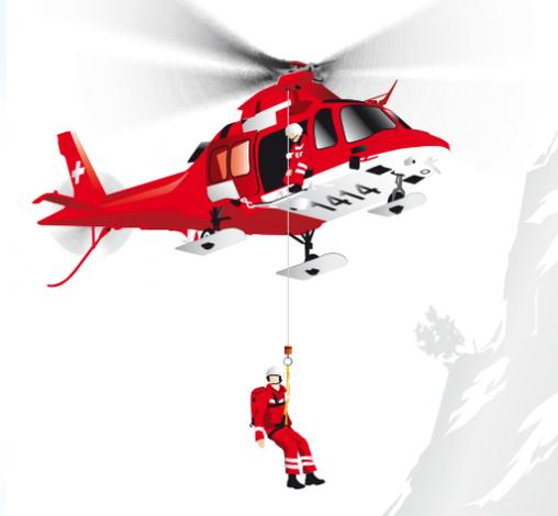
Der Windenoperator sichert den Notarzt und lässt ihn an der Rettungswinde zum Patienten hinunter. Da die Sicht des Piloten nach unten eingeschränkt ist, wird jede einzelne Aktion über die Bordsprechanlage kommuniziert: «Notarzt an der Winde gesichert ... Bereit zum Abwinden ... Arzt ab ... Winde läuft ... 80 Meter ... 60 ... 40 ... noch einen Meter zum Grund.»
